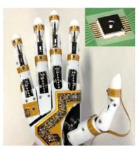
図2 ロボットハンド\*に実装した集積 化触覚センサ \*\*東京都立産業技術高等専門学校 空谷商権推教授提供
