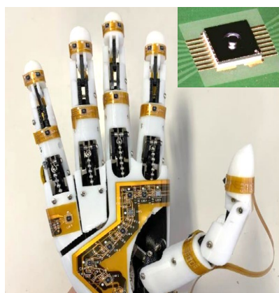
図2 ロボットハンド*に実装した集積 触覚センサ *東京都立産業技術高等専門学校 深谷直樹准教授提供
