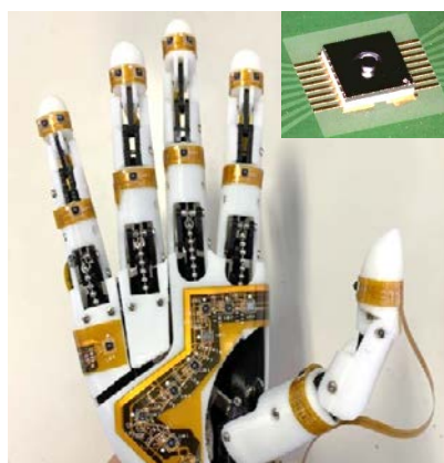
図2 ロボットハンド*に実装した集積化触覚センサ *東京都立産業技術高等専門学校 深谷直樹准教授提供
