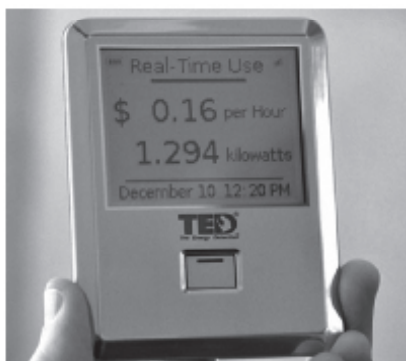
図例: Googleが提携しているEnergy, Inc.のTED(宅内エネルギーモニター装置)
